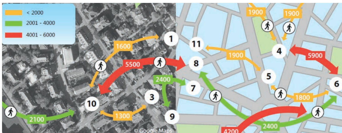
Figuur 32 – Registratie van gemiddeld dagelijks voetgangersverkeer aan de hand van wifi- en bluetoothsignalen van mobiele telefoons (bron: BlueScan (swisstraffic.ch))
