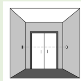
Figuur 11 – Schematische weergave van een geautomatiseerde telling met actief-infrarood
