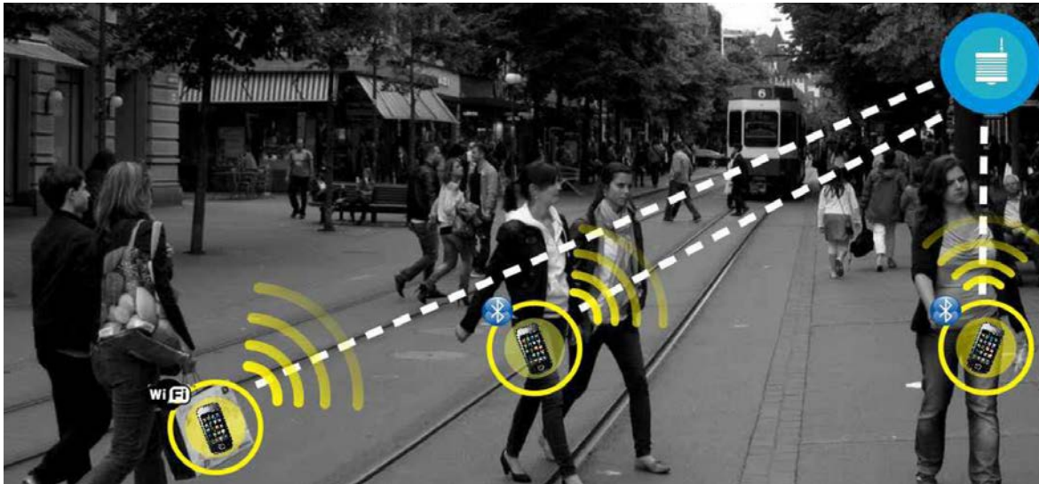
Figuur 32 – Registratie van gemiddeld dagelijks voetgangersverkeer aan de hand van wifi- en bluetoothsignalen van mobiele telefoons (bron: BlueScan (swisstraffic.ch))
