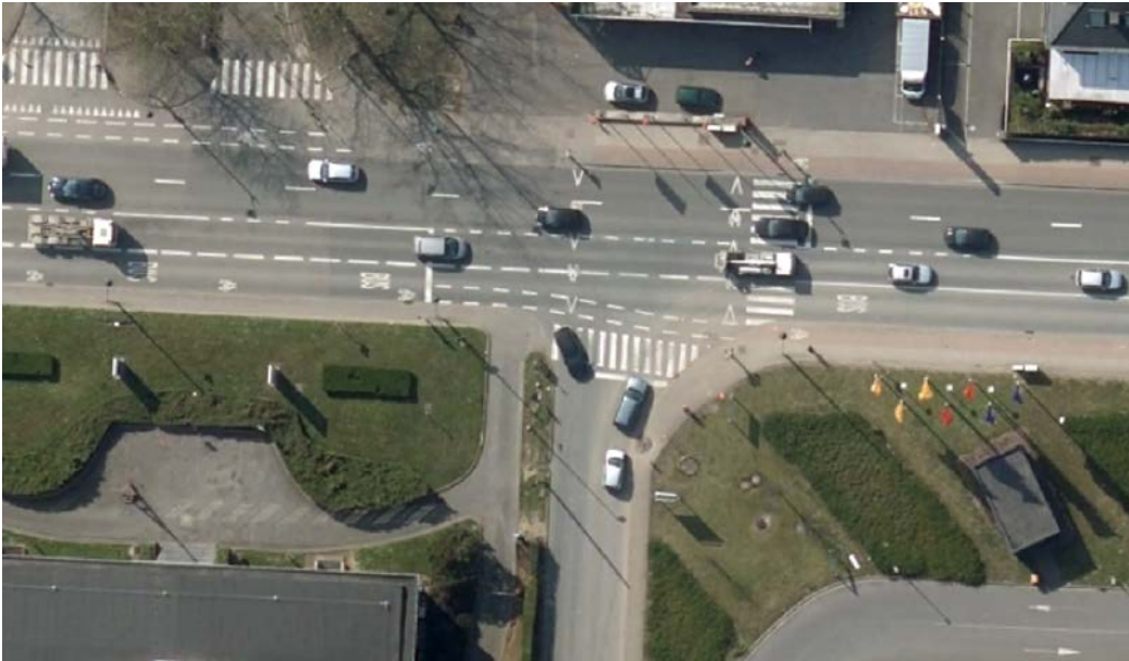
Illustration : sortie de la rue de Zuen sans feux tricolore alors que le trafic sur la chaussée de Mons et la traversée piétonne sont gérés par feux
