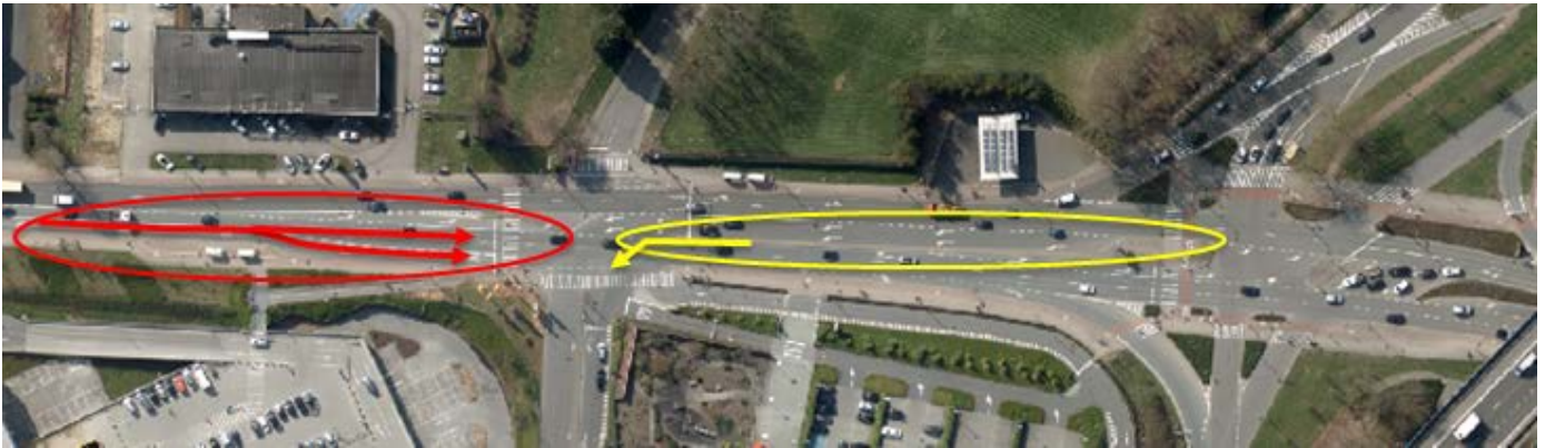
Illustration : en direction 'entrée ville', la longueur de la deuxième bande de présélection est trop faible pour assurer l'écoulement du trafic venant de Sint-Pieters-Leeuw (en rouge) ; La localisation centrale des bandes de circulation dédiées à l'accès d' IKEA et Coca-Cola (en jaune) implique de fortes répercussions lorsque celles-ci sont encombrées.
