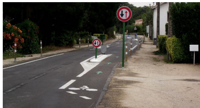
Figuur 8: Asverschuiving en vrije doorgang voor fietsers
