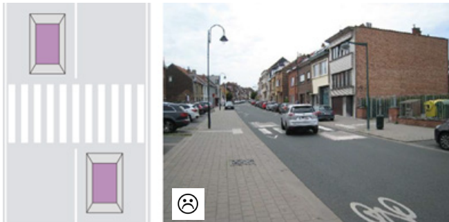
Figure 6 : Risque de comportement inapproprié en présence de coussins en chicane sans séparation physique [CRR 2020_1]
