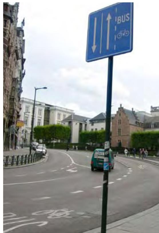
Figure 5.3. – Rue Ravenstein: exemple de couloir fermé en montée.
