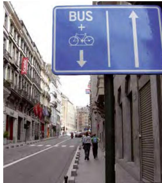
Figure 5.16. – Un exemple de couloir bus à contresens, séparé du reste du trafic par des bordures (voir 5.2.1.).
