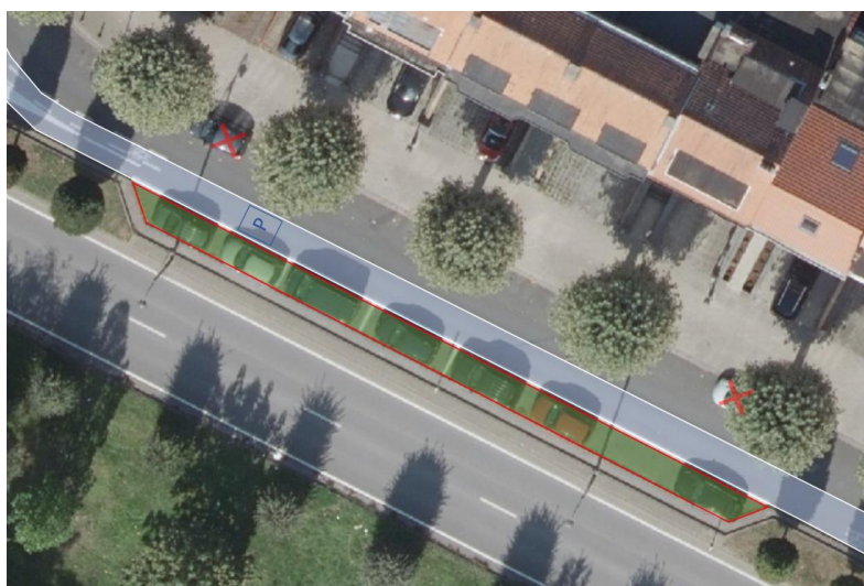
Illustration de la réorganisation du stationnement sur l'avenue des Croix du Feu : suppression des créneaux de stationnement au profit d'un stationnement longitudinal continu ; interdiction de stationnement en chaussée du côté habitation
