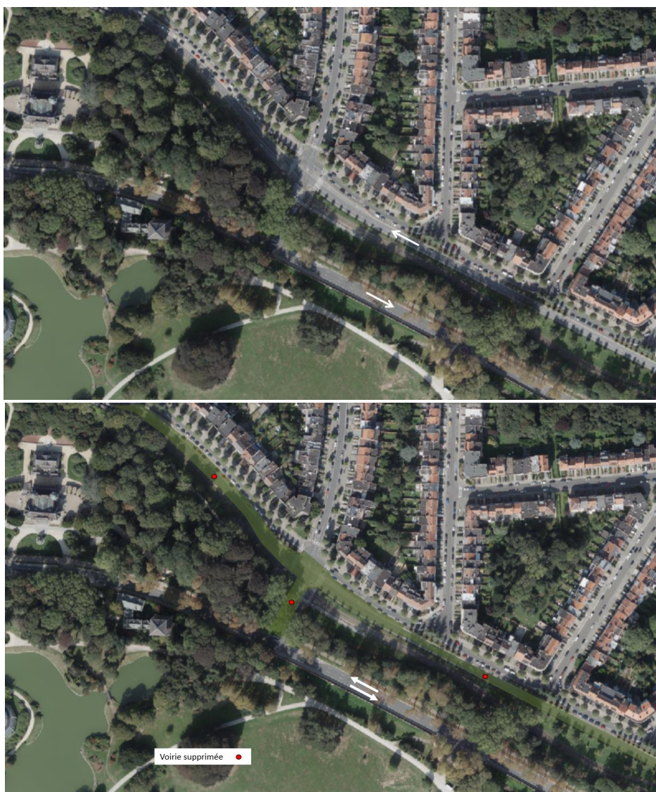
Suppression des deux bandes de trafic de transit (R21) de l'avenue des Croix du Feu et mise à double sens de l'avenue Van Praet
