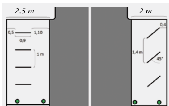
À gauche: un large espace de parking où les arceaux peuvent être positionnés perpendiculairement à la chaussée. À droite: un espace de parking étroit, mesurant 2 mètres, où les arceaux sont installés en biais, à 45°.
