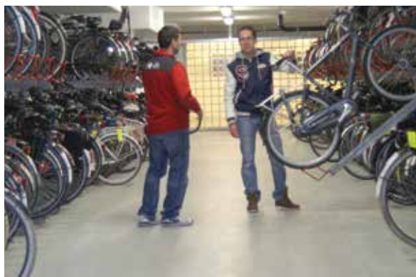
Grâce à l'utilisation de vérins pneumatiques, le poids à soulever ne constitue plus un obstacle pour les râteliers étagés.
