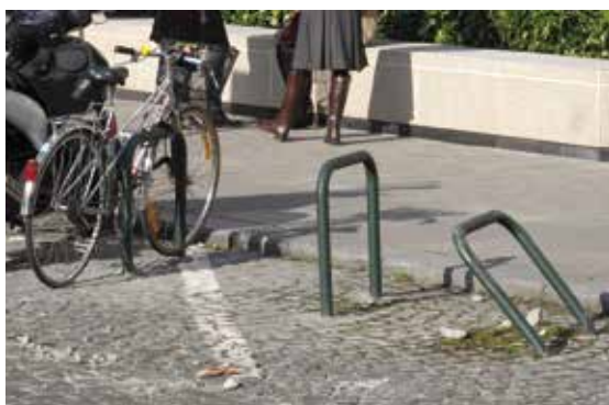
À gauche: un large espace de parking où les arceaux peuvent être positionnés perpendiculairement à la chaussée. À droite: un espace de parking étroit, mesurant 2 mètres, où les arceaux sont installés en biais, à 45°.
