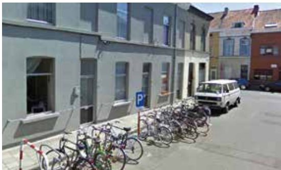
Mise en place d'un râtelier vélo de type Gand dans le prolongement de la bande de stationnement pour voitures.
