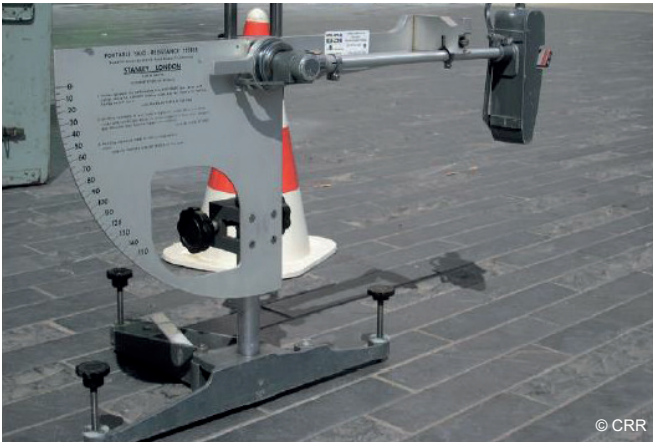
Mesure de l'adhérence d'une surface piétonne à l'aide du pendule SRT
