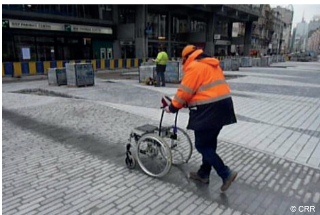
Un nouvel équipement développé par le CRR permet de mesurer le confort des revêtements piétons
