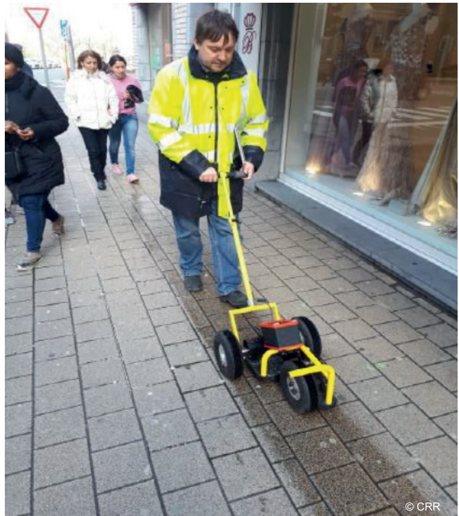
Mesure en continu de l'adhérence avec l'outil PFT
