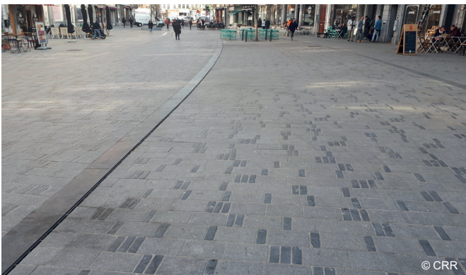
Revêtements alternants de la pierre naturelle polie et brute (à gauche). Au regard des surfaces polies existantes, le risque de glissade devrait être plus élevé à gauche que ci-dessous, où les pierres polies sont moins nombreuses et en alternance avec du granite
