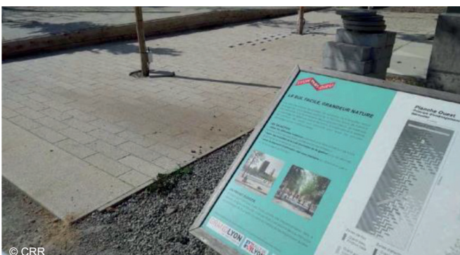
Planches d'essais de plusieurs revêtements piétons réalisées préalablement à différents aménagements piétons planifiés à Lyon
