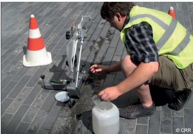
Mesure de l'adhérence d'une surface piétonne à l'aide du pendule SRT
