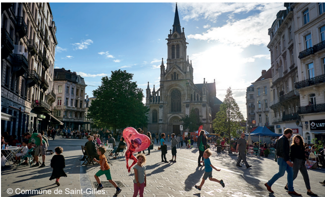
Parvis Saint-Gilles (Saint-Gilles) : revêtements piétons en granite de finition flammée (majoritaire) alternant avec quelques pierres bleues de finition adoucie, offrant une bonne qualité d'usage pour les piétons
